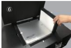
6、更换新风端中效滤网 将新的中效滤网按照滤网标签指示方向安装至原位
