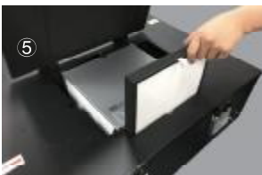
5、更换排风端滤网 将新的中效滤网安装至原位
