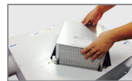
③ 将全热交换芯沿导轨垂直方 向取出，清理芯体层的灰尘
