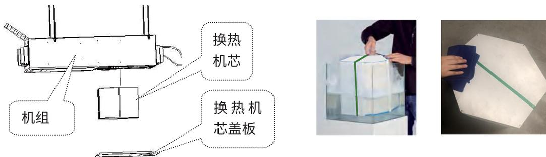
机组使用一段时间后，机芯上会粘有微小颗粒或其堆积，影响换热效果和使用效果，建议用户使用 1~2 年后进行一次清洗。清洗时可在清水池内加洗涤剂后进行浸泡，清水冲洗，最后用干布擦拭干净并晾干。待洗晾干后，将机芯重新装入机组内，并将盖板盖上。
