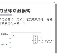
新风阀关闭, 风机以设定风速运行, 按设置湿度进行除湿工作。
