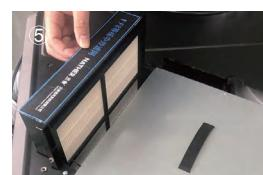
5、更换排风端滤网,将新的中效滤网按照标签指示方向安装至原位
