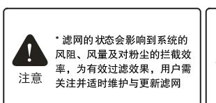
\* 滤网的状态会影响到系统的风阻、风量及对粉尘的拦截效率,为有效过滤效果,用户需关注并适时维护与更新滤网
