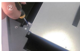
2、拧下高效全热交换芯两侧固定螺丝
