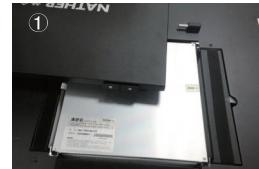
1、打开检修盖塑料搭扣,并平移取下检修盖
