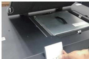
1、打开检修盖塑料搭扣,并平移热交换芯压片
