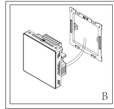
B: 正确接线后, 按图将控制面板安装到背板上, 即完成控制面板安装。
