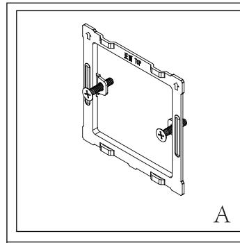
A: 将背板用螺丝固定在墙上开好的盒槽中。
