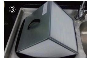
3、使用淋浴喷头简单冲洗,如果有必要可使用中性的液体清洁剂清洗(再用清水洗干净)
