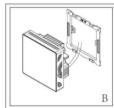
B: 正确接线后, 按图将传感器安装到背板上, 即完成传感器的安装。
